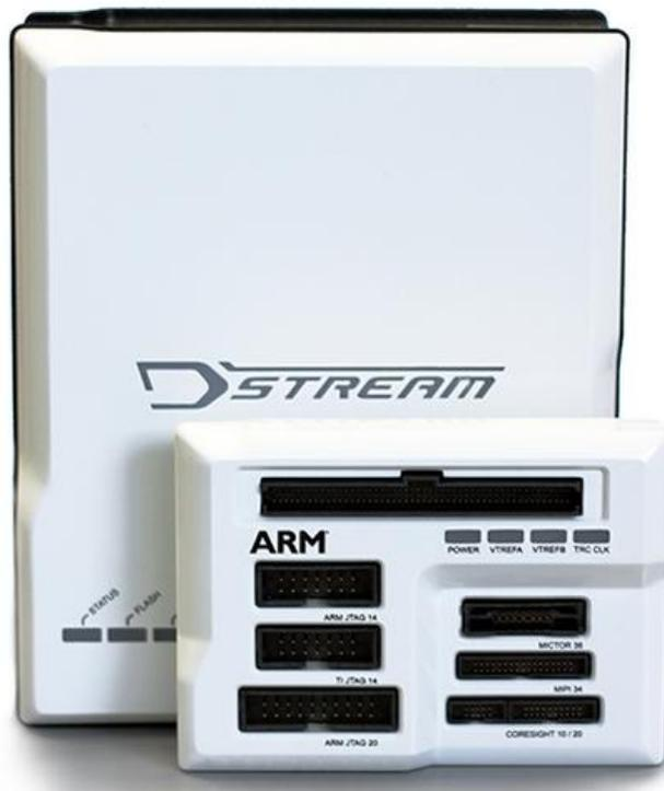
图 1-3 硬件调试器 DSTREAM
