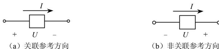
图 1.1 关联参考方向和非关联参考方向
