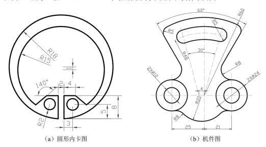
图 5-1 圆形内卡和机件平面图
