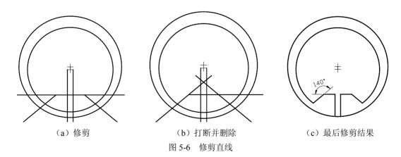
进行修剪时也可以使用打断命令或打断于点命令,将要修剪的线打断,然后删除不需要的部分,不过在线条比较多时,这样操作起来会比较麻烦。
